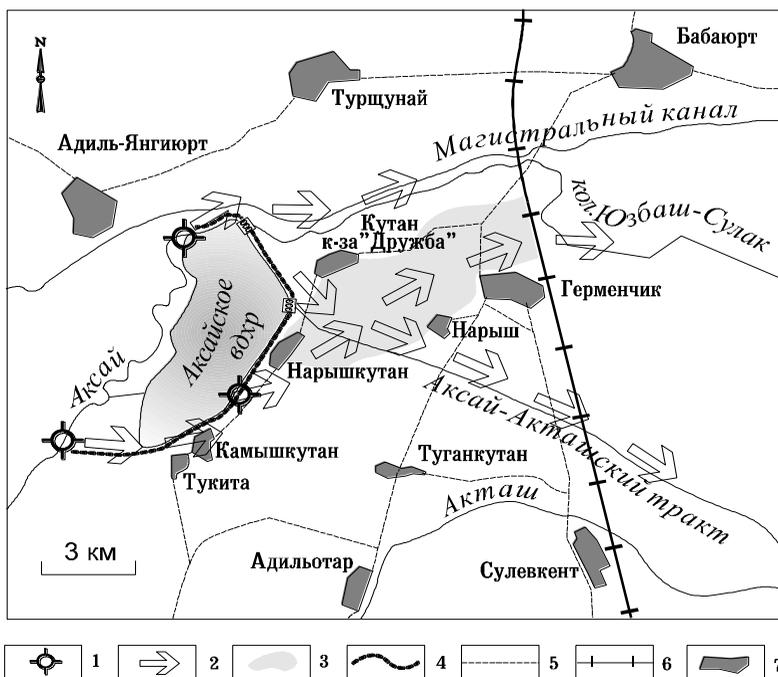
**Рис. 24. Схема расположения предполагаемых паводковых прорывов на Аксайском водохранилище**
