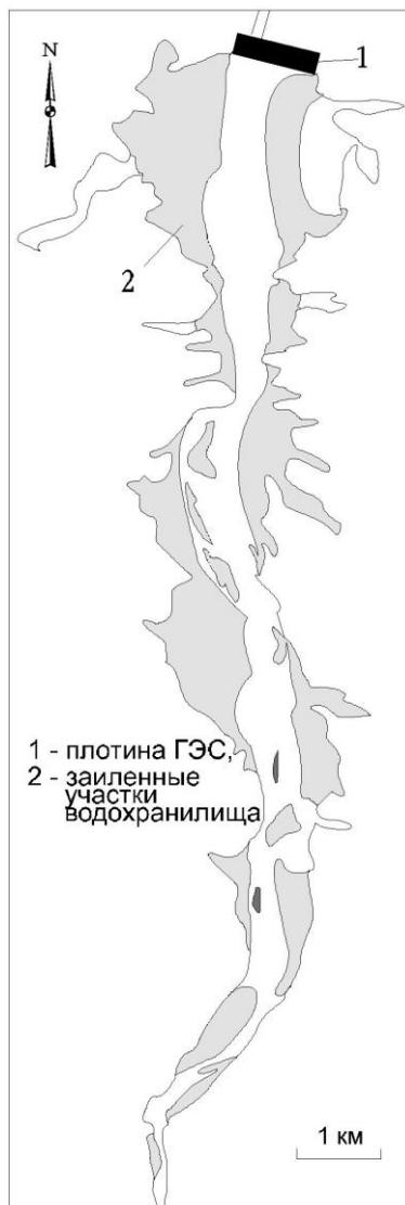
**Рис. 22. Схема Чирюртовского водохранилища**
